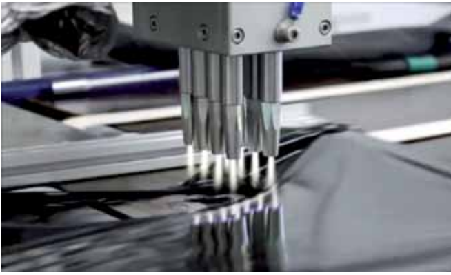
Mehrköpfiges Düsenmodul bei der Aktivierung einer Folie. Bei voller Leistung erwärmt sich die Folie und wird unbrauchbar.
